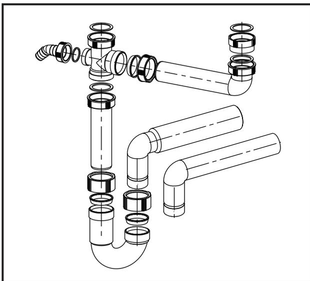
Ablaufverbindung mit exzentrischem Abgang, mit Rohrgeruchverschluss, mit Verlängerungsrohren D 40 und D 50
